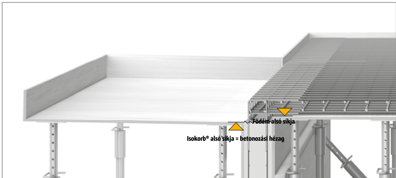
Ábra 41: Schöck Isokorb® T KL típus: zsaluzás és vasalás előkészítése a betonozáshoz. Betonozási munkahézag a falnál= erkély zsaluzás alsó síkja!
