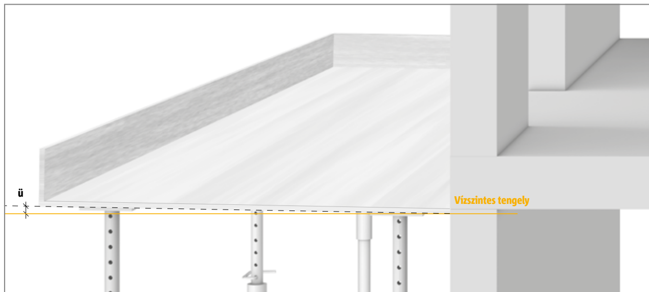
Ábra 25: A zsaluzat túlemelése a betonozás során
