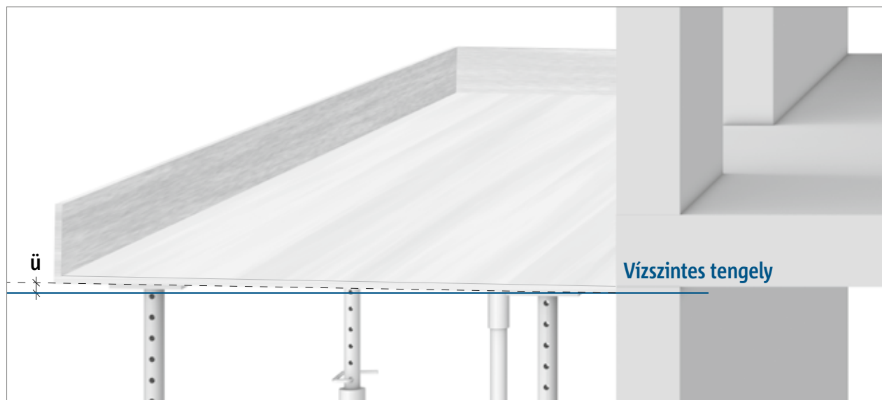
Ábra 13: A zsaluzat túlemelése a betonozás során
